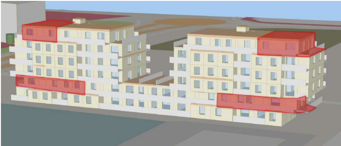
Scénario sans Brasseur d’air : 4 logements ne sont pas conformes >120h d’inconfort
